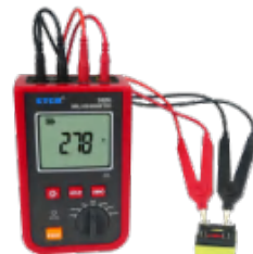
变压器线阻测量
